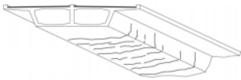
< PSC 박스거더의 균열 >
